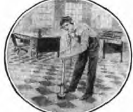
Il nuovo strumento che accerta il punto preciso in cui si trovano i fili elettrici nascosti nei palazzi moderni.
