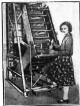
La macchina automatica che fa sperare in una diminuzione del prezzo delle scarpe, perchè può fare aumentare l'attuale produzione di calzature di ben dieciotto volte.
