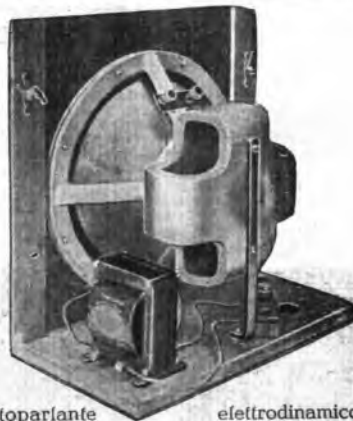
Altoparlante elettrodinamico con calamita permanente
