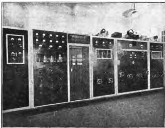
Complesso dei pannelli ad alta frequenza. Da sinistra a destra: oscillatore pilota, stadio modulatore ed amplificatore intermedio, stadio finale di potenza.
