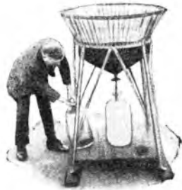
Gli apparecchi usati dagli inglesi per accertare la quantità di polvere che cade annualmente sulla città di Londra.
