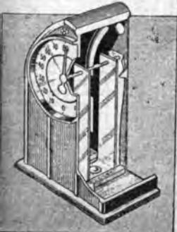
di una vista debole. Nella figura che riproduciamo si può osservare l'interno del nuovo termometro e la disposizione del metallo termostatico.
