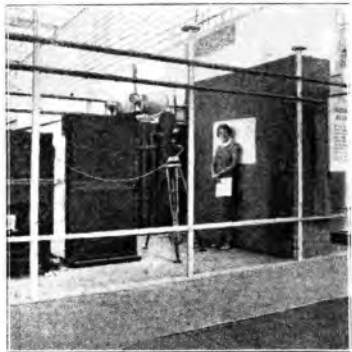
Trasmettitore di televisione col nuovo sistema a film intermediario.
