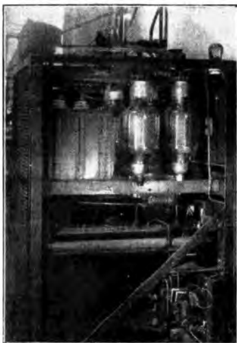
Particolare del dispositivo ad alta frequenza per il bombardamento delle valvole.
