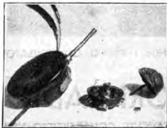
Apparecchio ricevitore a galena in un guscio di noce, costruito dall'avv. Pizzarello. Il padiglione della colla da misura delle dimensioni dell'originale apparecchio ricevente.
