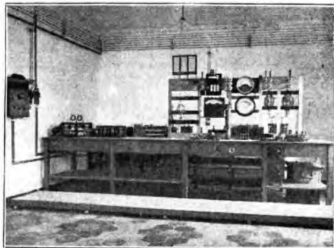
UNO DEI BANCHI DI PROVA PER VALVOLE TRASMITTENTI
