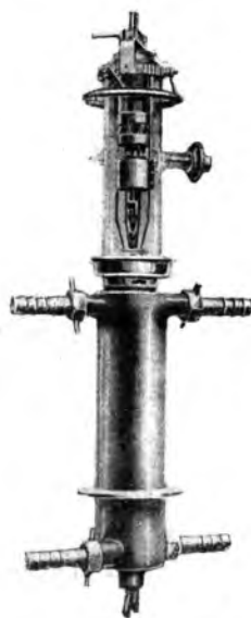
VALVOLA AD ANODO RAFFREDDATO MARCONI TIPO C. A. M. 3 DISSIPAZIONE 12 KILOWATT
