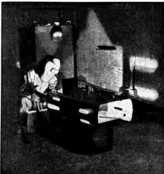
Saldatura di lamiere con idrogeno atomico.
