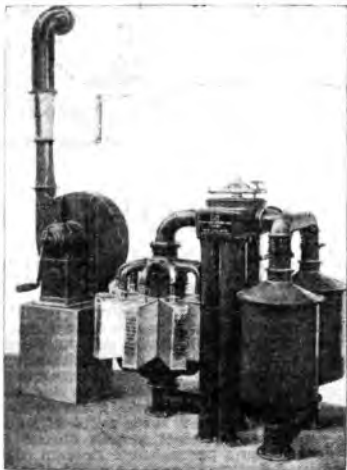
Un dispositivo a filtrazione e rigenerazione d'aria per ricovero antigas collettivo (S.I.C.A.).
