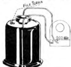
**Variantex** Antenna elettrica schermata con filtro regolabile: sostituisce antenna esterna regolando la sensibilità del ricevitore secondo le condizioni di ricezione, riducendo i disturbi atmosferici ad un minimo.
