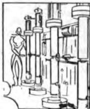
parecchie centinaia di chilowatt. Tali valvole sono più alte di un uomo e trasformano in calore durante il loro funzionamento centinaia di chilowatt. Quando si vogliono raggiungere potenze molto elevate si ricorre ad un banco di più valvole. Si costituiscono oggi amplificatori a più valvole che erogano una potenza media di centinaia di chilo-
