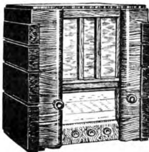
Il controllo automatico di sensibilità che è differito, agisce efficacemente entro vasti limiti su tutte le gamme. La amplificazione di bassa frequenza, il cui stadio finale è costituito da un pentodo, permette di ottenere un'ottima fedeltà di riproduzione entro la gamma acustica compresa fra 50 e 7000 cicli e per una potenza di uscita sino ad oltre 3 Watt, potenza più che sufficiente, ed anzi esuberante per il normale uso domestico.
