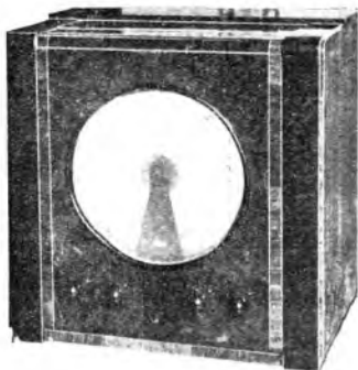
APPARECCHIO ACCESSO - La scala parlante proietta sulla seta di proiezione dell'altoparlante sotto forma di quadrante luminoso
