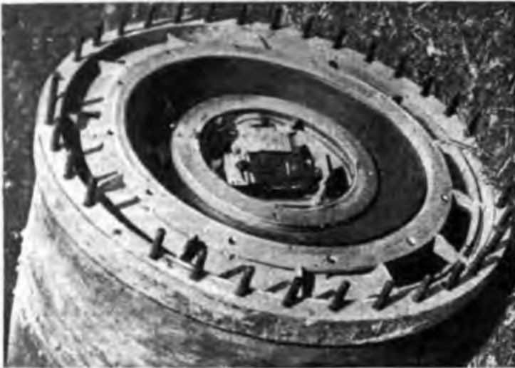
Questo è uno dei primi tipi di mine magnetiche. La fotografia qui mostra la parte superiore avvitata al centro e disposto l'apparecchio che governa le variazioni del campo magnetico prodotte dal passaggio di una nave. È visibile il comando a leva per la regolazione manuale della sensibilità. (L. C. Ph.)
