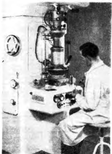
Il supermicroscopio, che realizza un ingrandimento di 40.000 volte, è di prezioso ausilio nello studio dei batteri.
