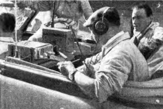
La macchina dei giornalisti in funzione: l'operatore con la cuffia sta ricevendo dai radiotelefonisti parigini sul Giro che verranno radiotrasmessi alla stazione radio-trasmittente campale, che fa da ponte radio alle stazioni di Roma e Sesto Calende.
