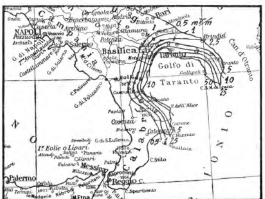
Fig. 7. - Zona di servizio diurna prevista per una stazione nel golfo di Taranto - 25 kW - 1448 kc/s - 207,1 metri.
