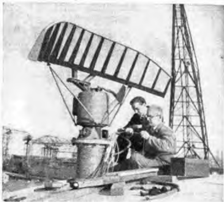
Tutte le navi si vanno oggi attrezzando con i più moderni impianti di navigazione. Su questo piroscafo sta per essere montato un nuovo tipo di schermo radar. La nave è dotata anche di timone automatico e di scandaglio sonico.
