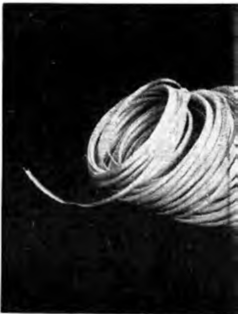
Fig. 4. — Campione di piattina bifilare flessibile usata per...
