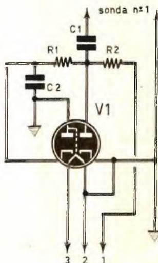
Fig. 4 - Con questo secondo tipo di sonda si possono misurare tensioni alternate la cui frequenza è compresa fra i 50 MHz e i 500 MHz. I componenti sono: V1 = EA52; C1 = 100 pF; C2 = 2.200 pF; R1 = 12 megaohm.
