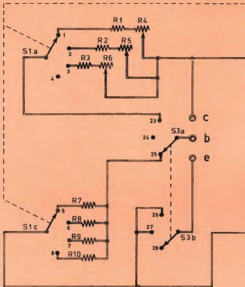
▲ Fig. 2 - Circuito completo del verificatore dei transistor. Le posizioni del commutatore multiplo S3 hanno le seguenti corrispondenze: 23-26 =  $\beta$ ; 24-27 = zero; 25-28 = fuga. Le sensibilità relative al commutatore S1d sono: 13 = 100 mA; 14 = 10 mA; 15 = 1 mA; 16 = 200 microampere.
