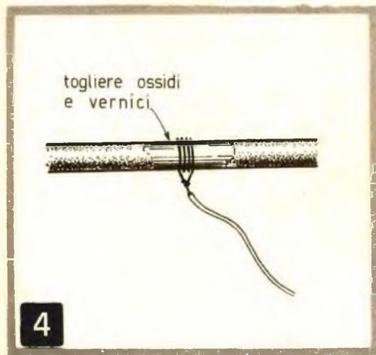
Quando si collega il filo di massa ad una tubatura metallica (acqua, termosifone, gas), occorre, prima dell'operazione, provvedere ad una energica pulizia della tubatura nel punto destinato al collegamento (fig. 4).
