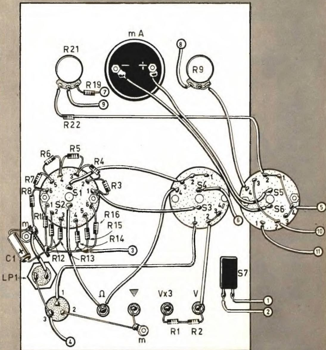
Fig. 6 - Cablaggio del voltmetro elettronico sulla parte posteriore del pannello frontale dello strumento.
