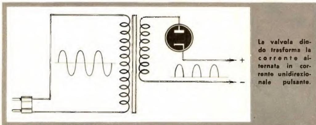
La valvola diodo trasforma la corrente alternata in corrente unidirezionale pulsante.
