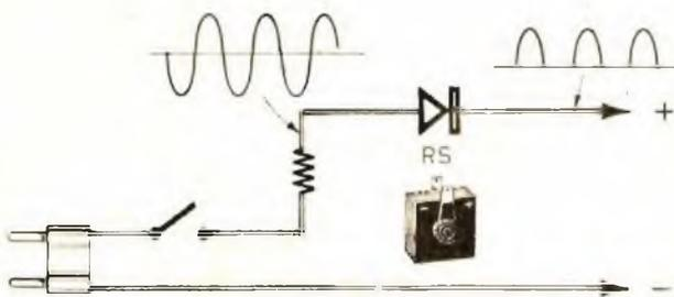
Il diodo raddrizzatore al selenio (RS) svolge le stesse funzioni della valvola diodo rivelatrice, trasformando la corrente alternata in corrente ad un sol senso.
