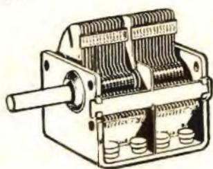
Il condensatore variabile, ad esempio, è costituito da più armature metalliche affiancate tra di loro e separate dall'aria. Il condensatore a carta è invece costituito da due fogli di carta metallizzata, separati da un foglio di carta paraffinata, avvolti tra di loro in modo da apparire esteriormente come un piccolo cilindro (questi condensatori vengono chiamati « a cartuccia »).
