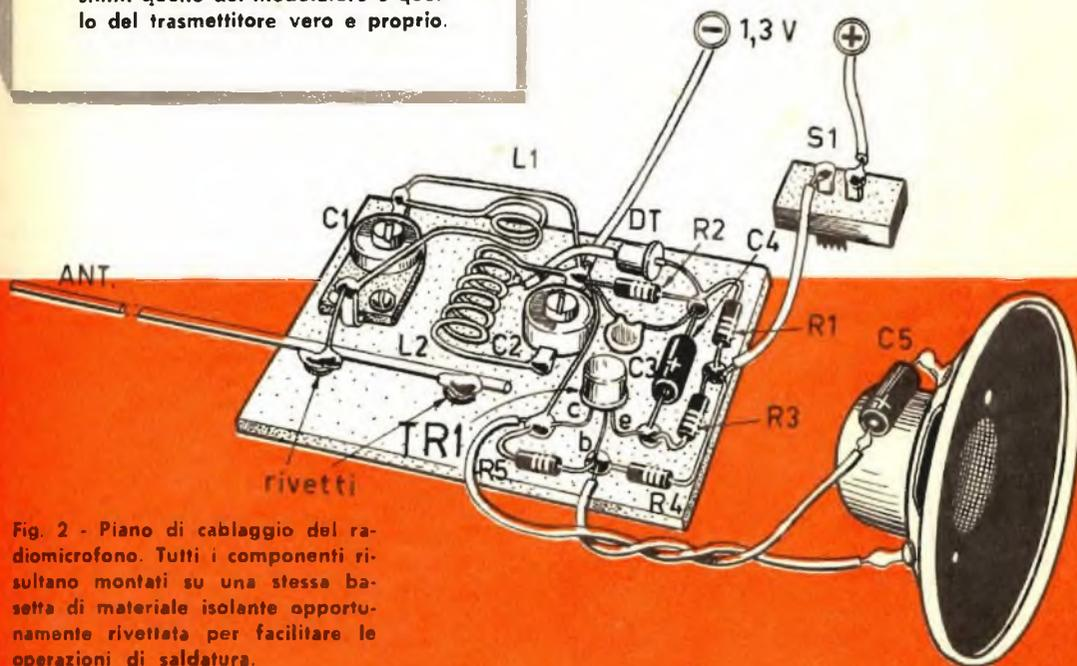
Fig. 2 - Piano di cablaggio del radiomicrofono. Tutti i componenti risultano montati su una stessa base di materiale isolante opportunamente rivettata per facilitare le operazioni di saldatura.
