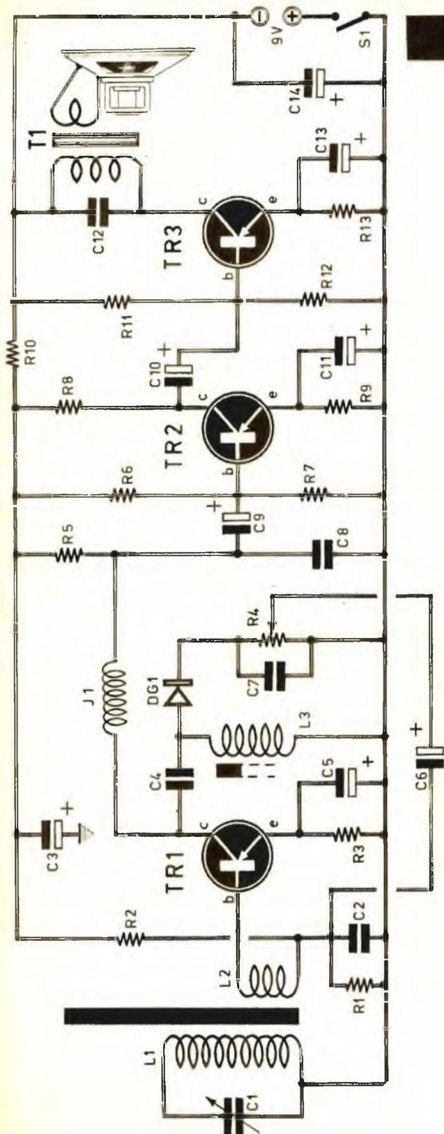
Fig. 1 - Circuito elettrico del ricevitore reflex a tre transistor.
