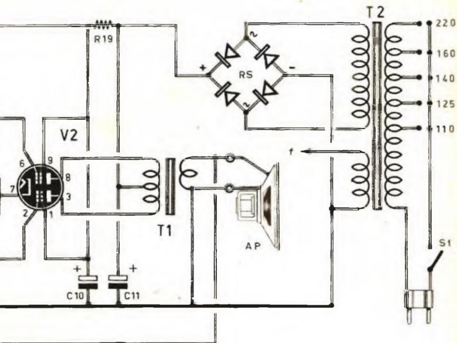
Fig. 1 - Circuito teorico completo dell'amplificatore di bassa frequenza a due valvole. Sull'estrema destra è rappresentato l'alimentatore a trasformatore e a raddrizzatore a ponte.
