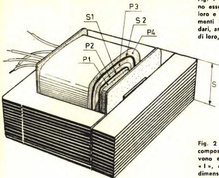
Fig. 2 - I lamierini necessari per la composizione del pacco lamellare devono essere del tipo ad «E» e ad «I», dello spessore di 0,5 mm. Le dimensioni riportate nel disegno sono espresse tutte in millimetri.
