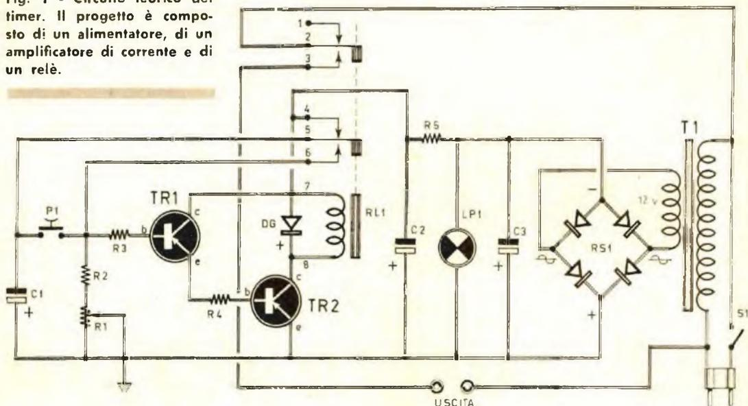
densatore C1 è scaricato, viene a mancare la tensione di polarizzazione di base del transistor TR1 e cessa quindi il funzionamento dell'amplificatore di corrente; il relè scatta una altra volta per ritornare nella posizione primitiva. La stessa sorte subiscono i contatti 2-3 del relè, che fanno parte del circuito di alimentazione dell'apparecchio applicato sulle bocche di uscita del circuito e che può essere rappresentato da un ingranditore fotografico, da un bromografo o altro apparato.
