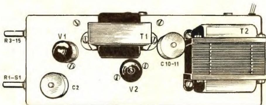
Fig. 3 - Nella parte superiore del telaio rettangolare risultano applicati: il trasformatore di alimentazione T2, quello di uscita T1, le due valvole amplificatrici V1-V2, il condensatore elettrolitico C2 e il condensatore elettrolitico doppio C10-C11. I due potenziometri risultano applicati all'estrema sinistra, in modo da evitare qualsiasi tipo di pannello frontale.
