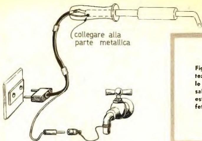
**Fig. 3 - Ecco l'esatto sistema di protezione dei circuiti radioelettrici dalle eventuali perdite di tensione del saldatore. Tutte le parti metalliche esterne dell'utensile risultano perfettamente collegate a massa.**
