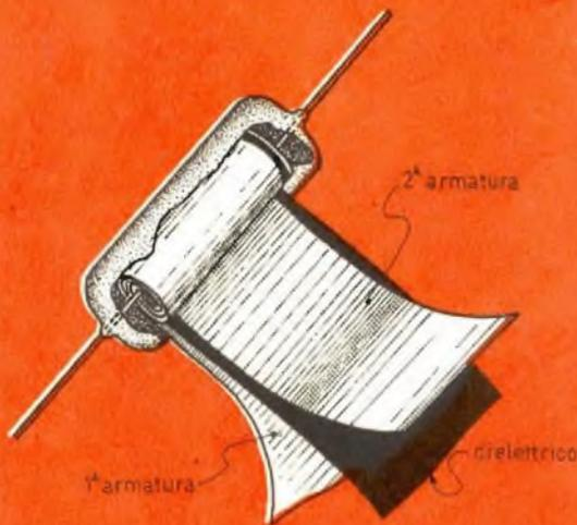
Fig. 6 - Il condensatore, di qualunque tipo esso sia, è formato da due armature affacciate e isolate tra di loro. Nel tradizionale condensatore a carta le armature sono rappresentate da due strisciole metalliche, mentre l'isolamento è ottenuto per mezzo di un foglio di carta, che rappresenta il dielettrico.
