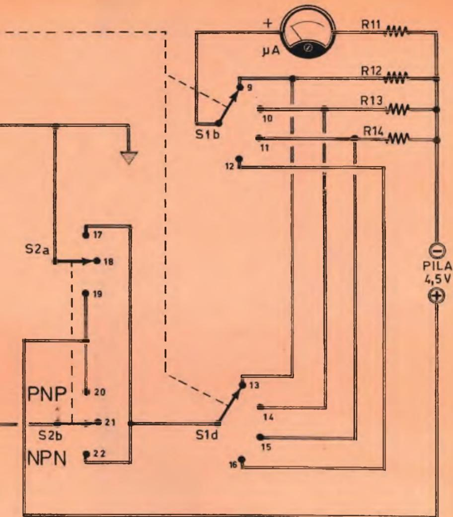
Fig. 3 - Piano di cablaggio dell'apparecchio necessario per il controllo dei transistor. Lo strumento verrà montato in un contenitore sul cui pannello frontale appariranno lo strumento indicatore, i commutatori, i potenziometri e i collegamenti per i transistor in prova.
