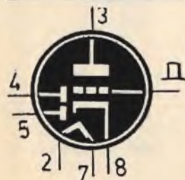
6R7 DOPPIO DIODO TRIODO AMPL. B.F.-RIV. (zoccolo octal)
