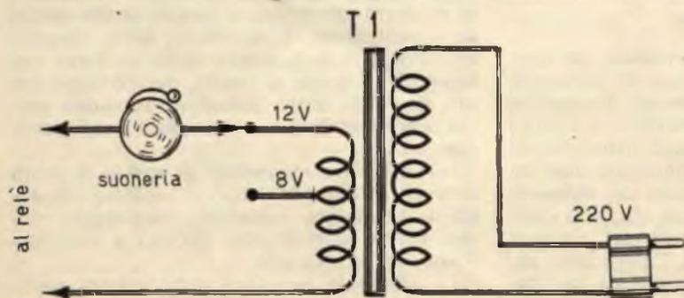
**Fig. 6 - Esempio di pratica applicazione del circuito con suoneria elettrica.**
