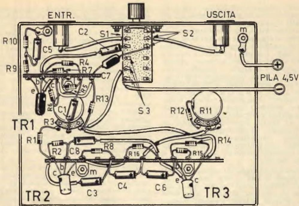
Fig. 1 - Il progetto del vibrato elettronico a 3 transistor è suddiviso in due sezioni: una sezione amplificatrice ed una sezione oscillatrice. La sezione oscillatrice produce variazioni di ampiezza del segnale elettrico proveniente dallo strumento musicale con un ritmo di 5-15 volte al secondo.
