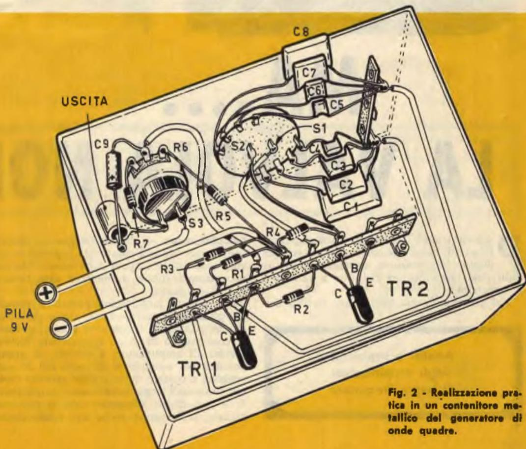
**Fig. 2 - Realizzazione pratica in un contenitore metallico del generatore di onde quadre.**
