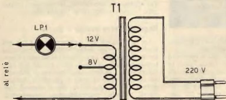
**Fig. 5 - Esempio di pratica applicazione del circuito con lampada spia a 12 volt.**
