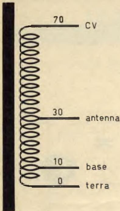
Fig. 3 - Quando si avvolge la bobina occorre ricordarsi di ricavare le due prese intermedie alla 10<sup>a</sup> e alla 30<sup>a</sup> spira.
