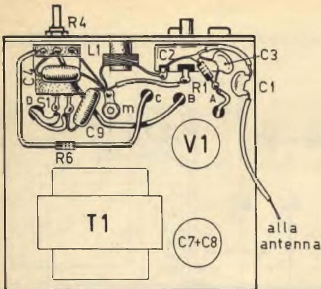
Fig. 3 - Nella parte superiore del telaio metallico risultano montati il trasformatore di alimentazione, la valvola, il condensatore elettrolitico doppio, il circuito di alta frequenza e il potenziometro di controllo del volume sonoro.
