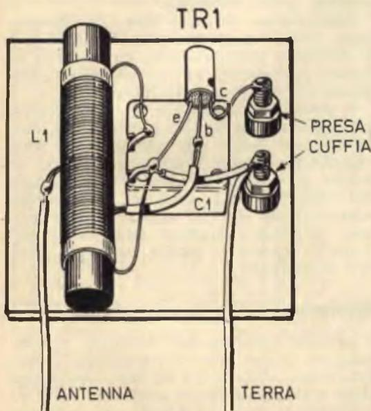
Fig. 1 - Il circuito elementare del ricevitore Mignon si compone di una bobina, un condensatore variabile, un transistor e una cuffia.
