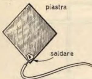
**Fig. 3 - La piastra metallica costituisce l'elemento sensibile dell'apparecchio.**
