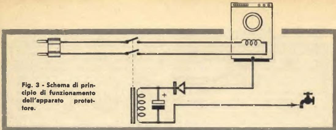
**Fig. 3 - Schema di principio di funzionamento dell'apparato protettore.**
