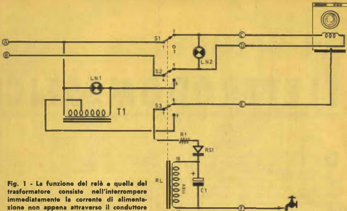
Fig. 1 - La funzione del relè e quella del trasformatore consiste nell'interrompere immediatamente la corrente di alimentazione non appena attraverso il conduttore di massa fluisce la corrente elettrica.
