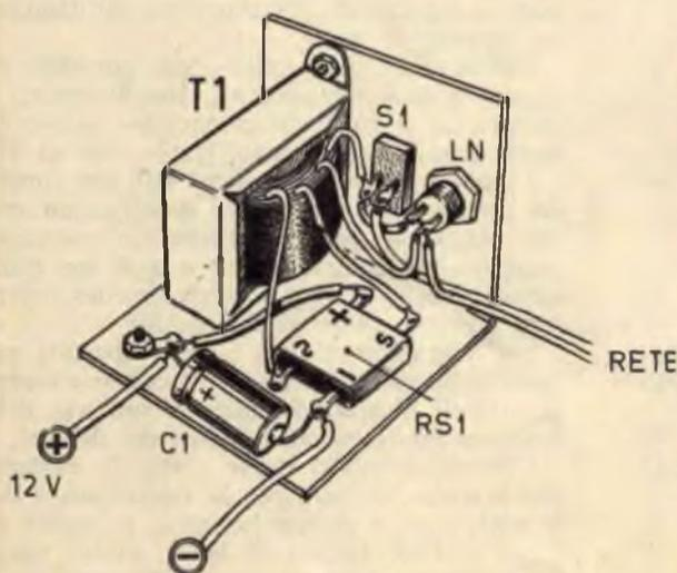
Fig. 3 - L'alimentazione a 12 volt prevede l'uso di un trasformatore, di una lampada-spia, di un raddrizzatore e di un condensatore elettrolitico.
