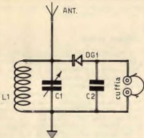
Fig. 3 - Circuito teorico di radoricevitore elementare.
