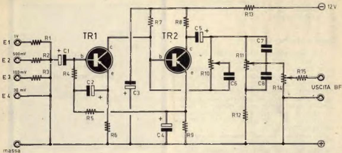
Fig. 1 - Il circuito elettrico del preamplificatore-correttore è caratterizzato dalla presenza di quattro entrate diverse.
