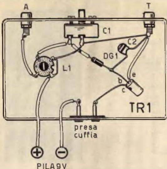
Fig. 5 - Realizzazione pratica del ricevitore elementare con amplificatore a transistor.
