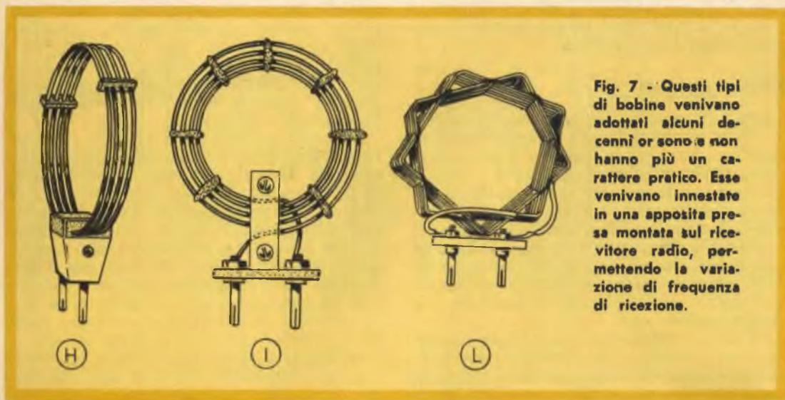
Fig. 7 - Questi tipi di bobine venivano adottati alcuni decenni or sono e non hanno più un carattere pratico. Esse venivano innestate in una apposita presa montata sul ricevitore radio, permettendo la variazione di frequenza di ricezione.
