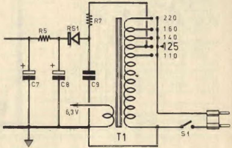
Fig. 2 - Variante al circuito di alimentazione ottenuta con l'uso di un autotrasformatore.
