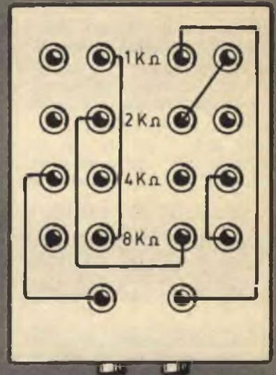
Fig. 3 - Esempio di prelievo del valore resistivo di 5636 ohm.
