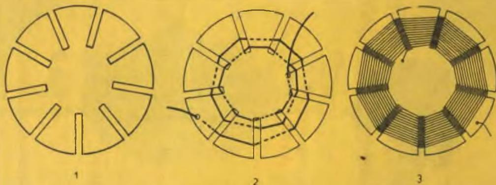
**Fig. 8 - La bobina a fondo di paniero, qui sopra rappresentata nella breve sequenza costruttiva, rappresenta una pietra miliare della futura carriera di ogni radioamatore. Il supporto è di cartone, munito di nove aperture radiali. Dal numero delle spire dipende il potere ricettivo dell'apparecchio radio.**
