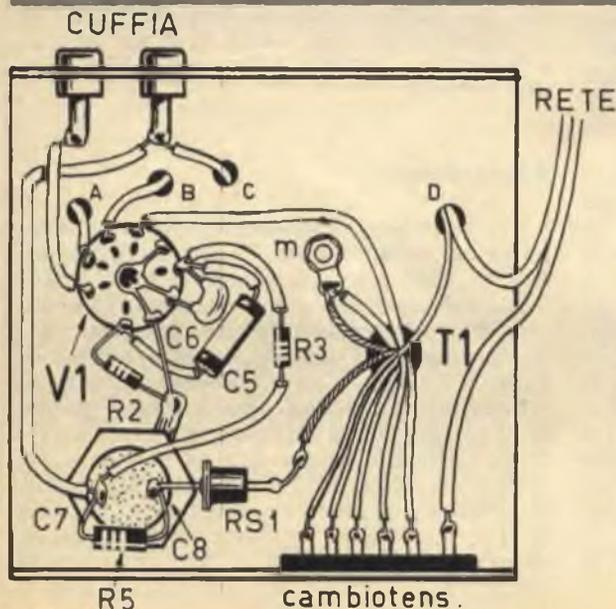
Fig. 4 - Piano di cablaggio del ricevitore ad 1 valvola, con ascolto in cuffia, visto nella parte di sotto del telaio metallico. Gli elementi fondamentali sono: il circuito di alimentazione e quello della valvola V1.
