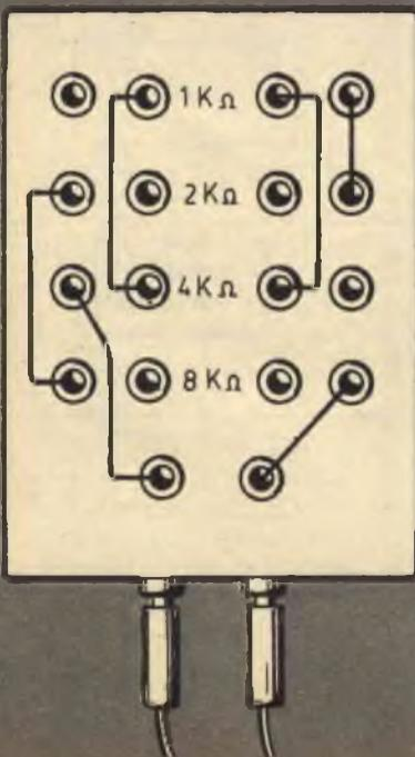
Fig. 5 - Esempio di prelievo del valore resistivo di 10800 ohm.
