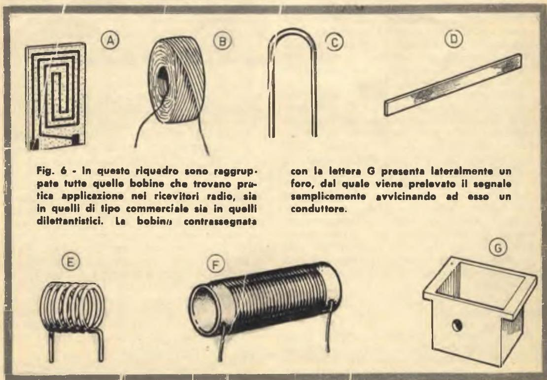
Fig. 6 - In questo riquadro sono raggruppate tutte quelle bobine che trovano pratica applicazione nei ricevitori radio, sia in quelli di tipo commerciale sia in quelli dilettantistici. La bobina contrassegnata
