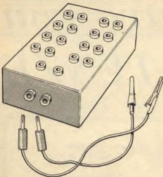
Fig. 1 - La cassetta di legno, che permette di prelevare 96 valori resistivi diversi, è munita di due conduttori per il collegamento tra la cassetta stessa e il circuito in esame.
