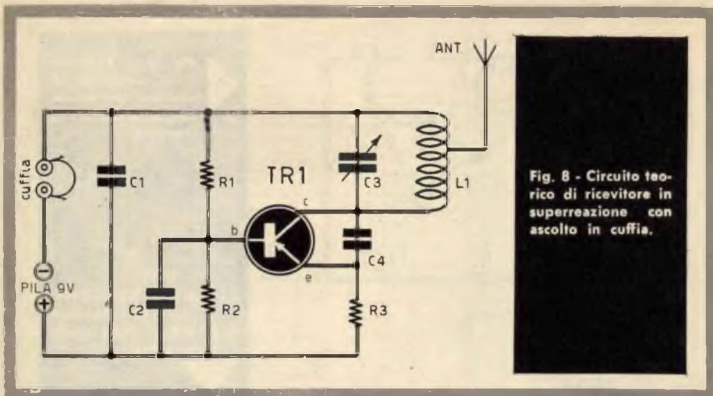
**Fig. 8 - Circuito teorico di ricevitore in superreazione con ascolto in cuffia.**
