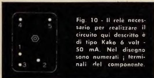
Fig. 10 - Il relè necessario per realizzare il circuito qui descritto è di tipo Kako 6 volt - 50 mA. Nel disegno sono numerati i terminali del componente.
