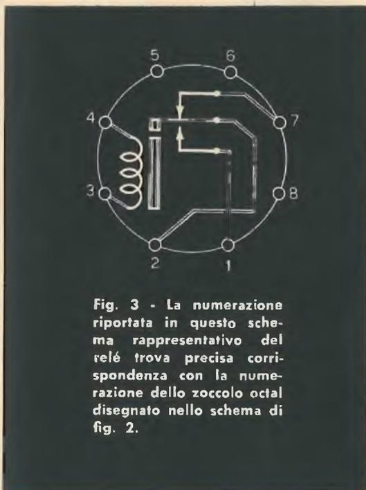
Fig. 3 - La numerazione riportata in questo schema rappresentativo del relé trova precisa corrispondenza con la numerazione dello zoccolo octal disegnato nello schema di fig. 2.
