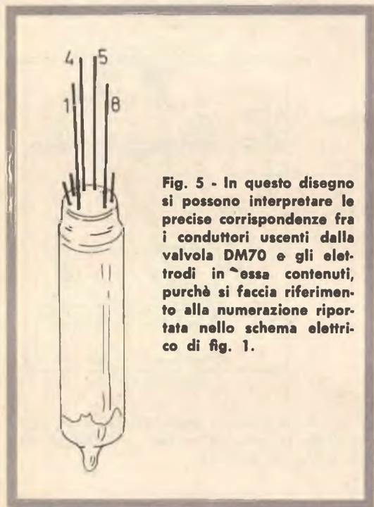
**Fig. 5 -** In questo disegno si possono interpretare le precise corrispondenze fra i conduttori uscenti dalla valvola DM70 e gli elettrodi in essa contenuti, purchè si faccia riferimento alla numerazione riportata nello schema elettrico di fig. 1.
