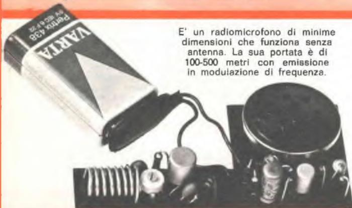
E' un radiomicrofono di minime dimensioni che funziona senza antenna. La sua portata è di 100-500 metri con emissione in modulazione di frequenza.
