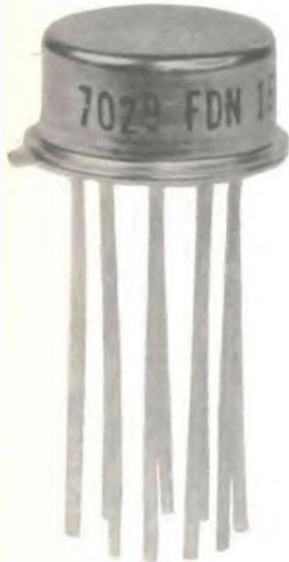
Fig. 3 - Contenitore di circuito integrato prodotto in serie dalla Philips. Si notino i molti terminali, necessari per i collegamenti al circuito utilizzatore.
