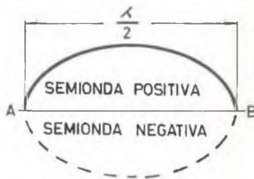
Molti di voi conoscono l'espressione  $V \times A = W$ ; cioè la potenza misurata in Watt (W) è data dal prodotto della tensione in Volt (V) per l'intensità di corrente in Ampère (A). Fatta questa premessa vediamo di rappresentare l'andamento della corrente, della tensione e dell'impedenza su una antenna a mezza onda. L'andamento della corrente è rappresentato in Figura 6.
