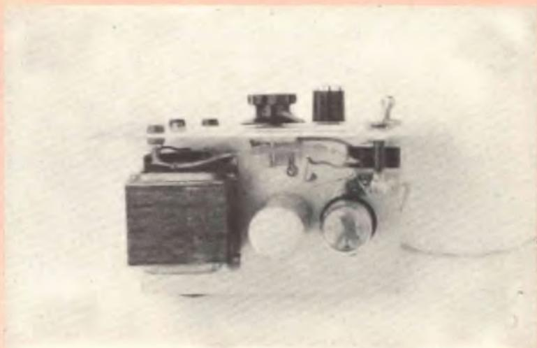
Ecco come appare l'apparecchio, a montaggio ultimato. Sul telaio a squadra, da una parte il trasformatore, gli elettrolitici, la valvola; dall'altra, le resistenze, i condensatori, i collegamenti.
