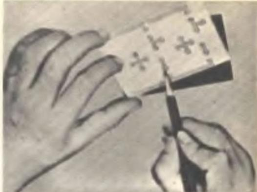
**Fig. 5 - Foto illustrante la tecnica di riproduzione grafica del circuito stampato sulla carta-matrice, con l'aiuto di una matita. Questa operazione può essere eseguita anche per ricalco da un originale a grandezza naturale, con l'interposizione di un foglio di carta carbone.**
