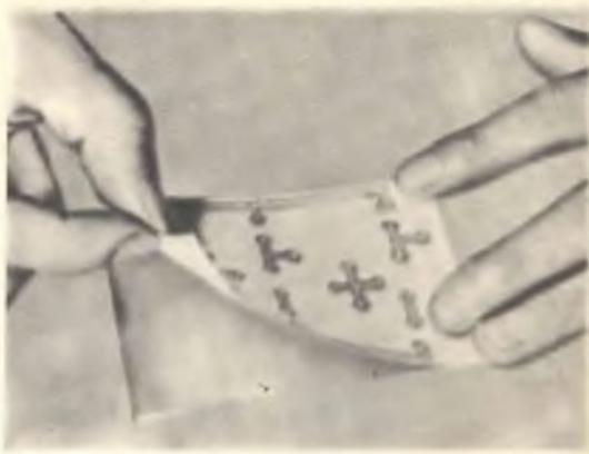
**Fig. 7 - L'applicazione della carta-matrice adesiva al rame, dopo averla liberata dal suo supporto, deve essere eseguita evitando che le dita dell'operatore tocchino il metallo lucidato.**
