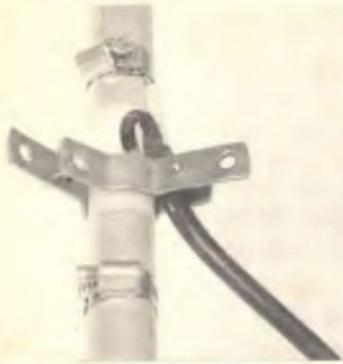
Particolare del collegamento del cavo coassiale alla ground-plane: si noti la ralla per controventature da noi impiegata come « porta radiali ».
