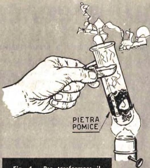
Fig. 3 - Dopo aver incendiato i fumi che escono dall'imboccatura della provetta, occorre mantenere la stessa sopra la fiamma per conservare il fenomeno delle fiammate.
