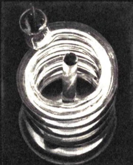
a) Il Laser è un dispositivo estremamente semplice; grande poco più di un normale bicchiere da tavola, consta di una spirale di vetro in funzione di flash elettronico e di un rubino sintetico, di forma cilindrica, posto al centro.
