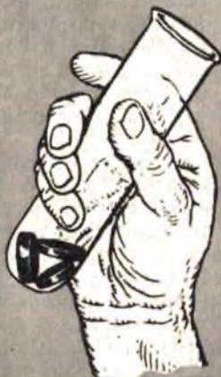
Fig. 5 - A liquefazione avvenuta si capovolge la provetta versando il contenuto su una piastrina di ceramica. Si otterrà una sottile lamina bianco-lucente simile all'argento.
