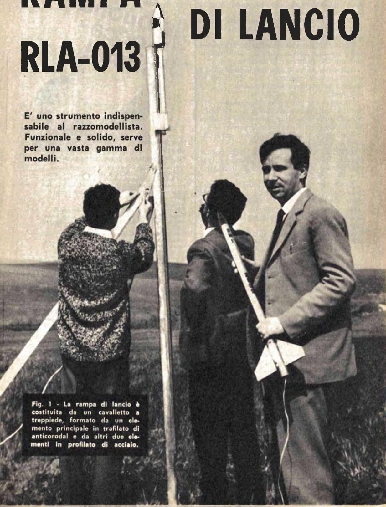
**Fig. 1 - La rampa di lancio è costituita da un cavalletto a treppiede, formato da un elemento principale in trafilato di anticorodal e da altri due elementi in profilato di acciaio.**
