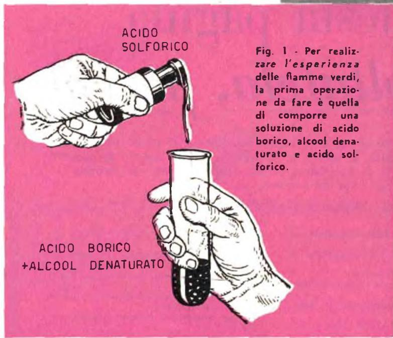
Fig. 1 - Per realizzare l'esperienza delle fiamme verdi, la prima operazione da fare è quella di comporre una soluzione di acido borico, alcool denaturato e acido solforico.
