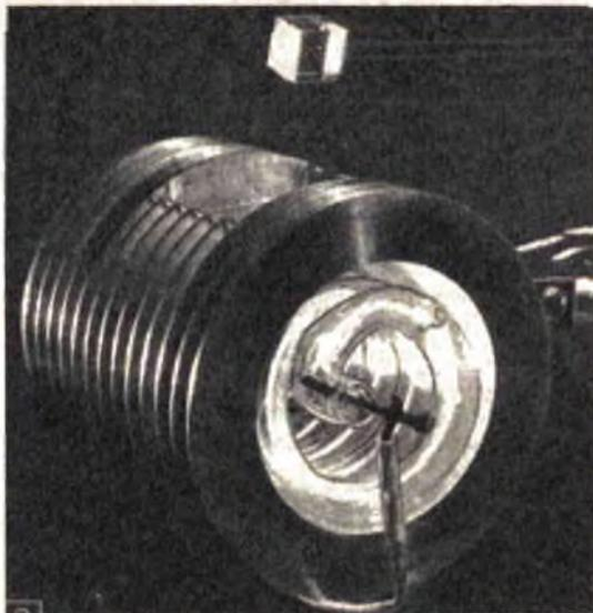
b) L'involucro ad alette che circonda l'unità del Laser contribuisce alla concentrazione dell'intensità della luce prodotta dal flash e al raffreddamento di quest'ultimo. Il rubino cubico usato nei primi esperimenti risultava lucente per la luce assorbita.
