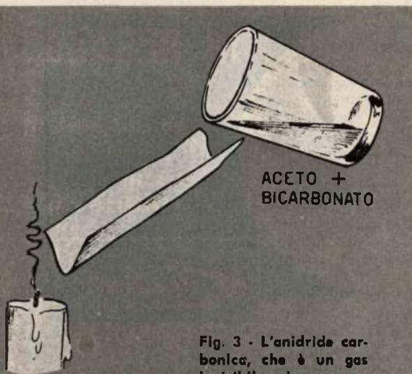
Fig. 3 - L'anidride carbonica, che è un gas invisibile, si versa come un comune liquido. Con essa si può spegnere la fiamma di una candela servendosi del sistema rappresentato in figura.
