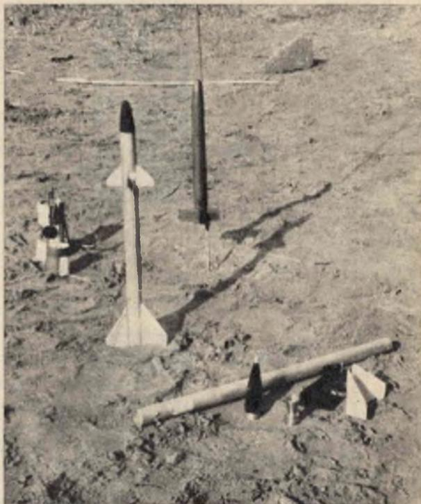
Fig. 1 - Il lancio del razzo avverrà da una piattaforma o meglio ancora da una guida a canale inclinabile per una migliore sicurezza di tiro.
