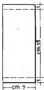
Fig. 1 - Dopo aver tagliato il pezzo di lamiera nelle dimensioni volute, occorre fissare sopra di esso un foglio di carta millimetrata, facendo combaciare le righe della carta con i lati perimetrali della lamiera. Sulla carta si disegneranno le linee di piegamento, i fori e le finestre.
