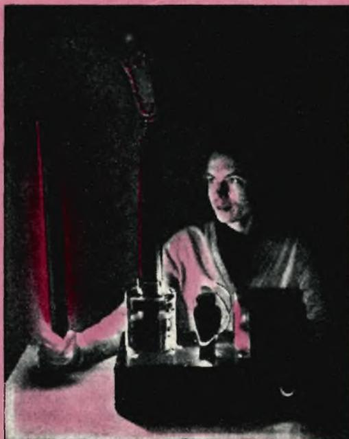
Fig. 2 - Tenendo in mano una lampada elettrofluorescente, vicino al trasformatore di Tesla, essa si accende. Il corpo stesso funge da antenna e trasmette energia alla lampada.
