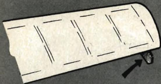
Fig. 3 - Il pareggio della incidenza si raggiunge facilmente aggiungendo un alettone di cartoncino o di celluloido all'estremità dell'ala che si abbassa durante la virata.
