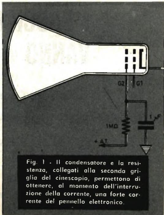
Fig. 1 - Il condensatore e la resistenza, collegati alla seconda griglia del cinescopio, permettono di ottenere, al momento dell'interruzione della corrente, una forte corrente del pennello elettronico.
