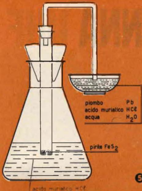
sciogliere il piombo con l'acido cloridrico, che lo trasforma in cloruro; quando il piombo si è sciolto si provvederà a diluire la soluzione con acqua, provvedendo a riscaldarla al momento dell'uso.
