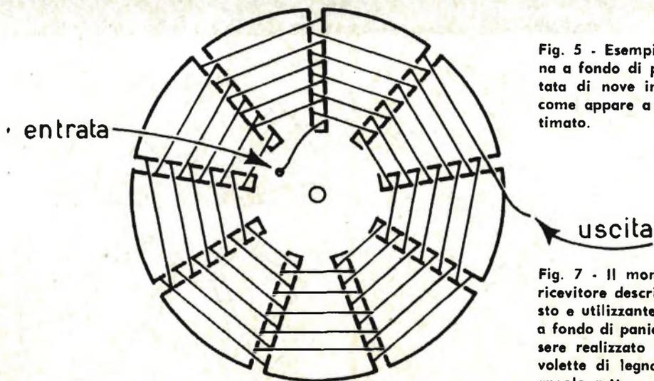
Fig. 5 - Esempio di bobina a fondo di panierino dotata di nove intagli, così come appare a lavoro ultimato.
