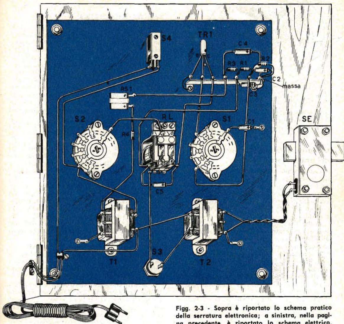
Figg. 2-3 - Sopra è riportato lo schema pratico della serratura elettronica; a sinistra, nella pagina precedente, è riportato lo schema elettrico.
