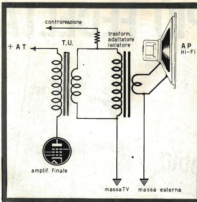
Fig. 1 - Quando si vuole applicare al televisore un altoparlante ad alta fedeltà, occorre utilizzare un trasformatore d'uscita in grado di garantire un perfetto adattamento di impedenza e un corretto isolamento dell'altoparlante dal telaio del televisore.
