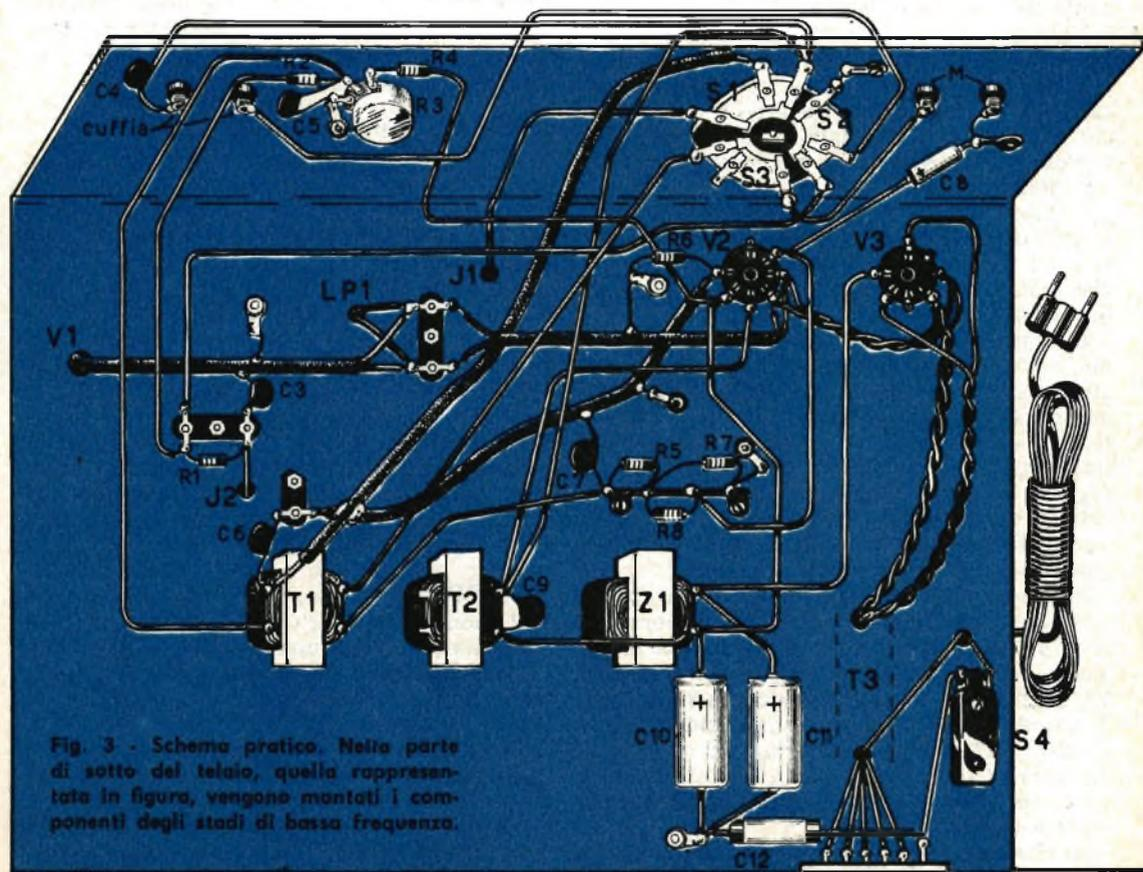
Fig. 3 - Schema pratico. Nella parte di sotto del telaio, quella rappresentata in figura, vengono montati i componenti degli stadi di bassa frequenza.
