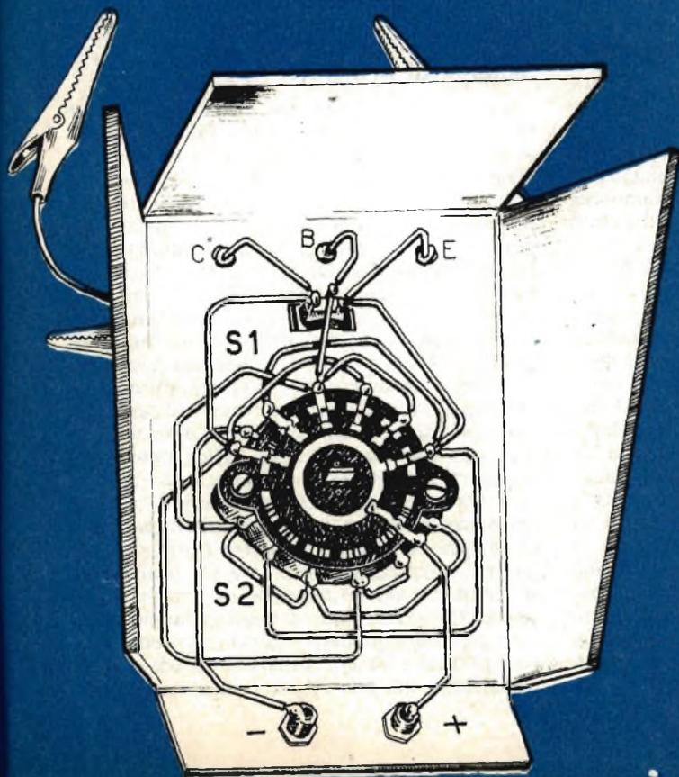
Fig. 1 - Schema elettrico del circuito provatransistori.
