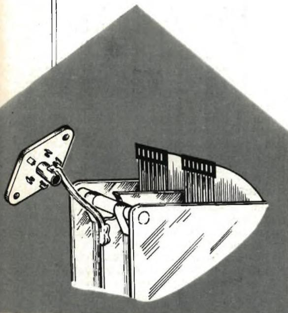
La bobina L3, che collega le due griglie controllo del doppio triodo 6J6, verrà fissata direttamente sui piedini 5-6 dello zoccolo della valvola V1. Sempre nella camera schermata, che racchiude i componenti lo stadio di AF, verranno applicate le due impedenze di alta frequenza J1 e J2; anche il condensatore a mica C2 da 3000 pF risulterà connesso fra l'impedenza J1 e la massa del condensatore variabile C1.
