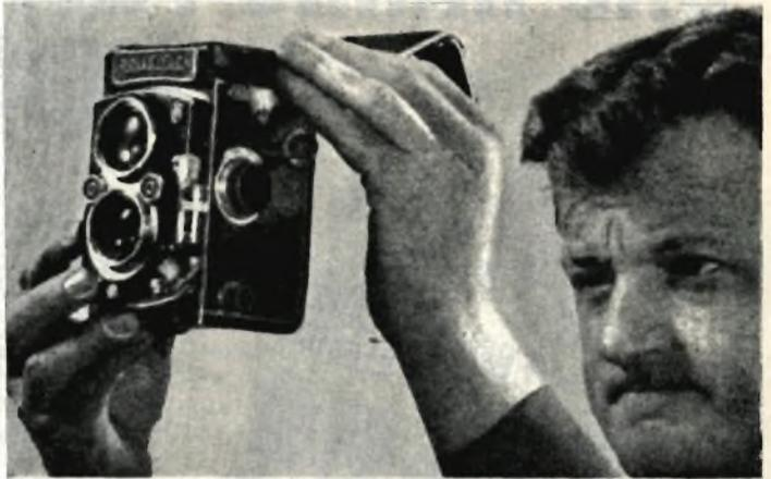
Un primo importante controllo della macchina fotografica consiste nel guardare attraverso l'obiettivo della parte posteriore, mentre si regolano otturatore e diaframma sulle loro diverse posizioni.
