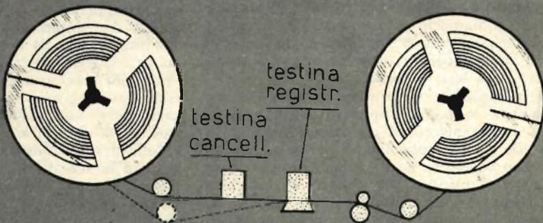
Fig. 2 - Il disegno illustra il metodo più semplice per ottenere la sovrainpressione. Per evitare la cancellazione basta sistemare davanti all'apposita testina un pezzetto di cartone, di plastica o, un lamierino di alluminio dello spessore di 1 mm.
