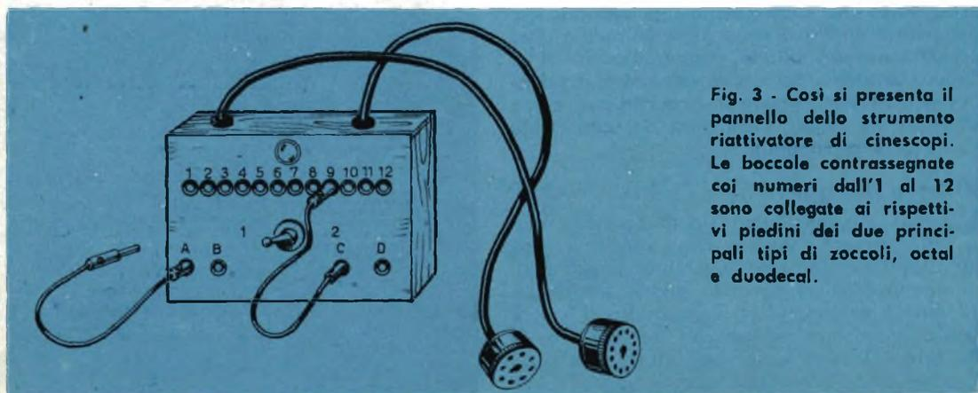
Fig. 3 - Così si presenta il pannello dello strumento riattivatore di cinescopi. Le boccole contrassegnate coi numeri dall'1 al 12 sono collegate ai rispettivi piedini dei due principali tipi di zoccoli, octal e duodecal.
