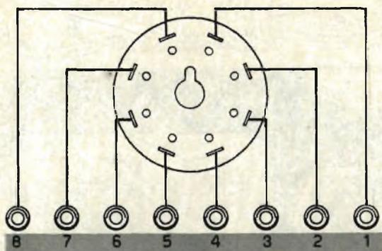
Fig. 6 - Schema elettrico dell'insieme dei collegamenti alle 12 boccole e ai piedini dei due tipi di zoccoli, octal e duodecal.
