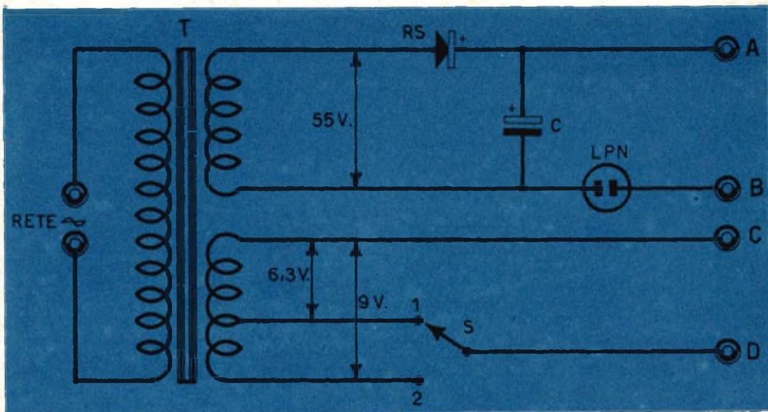
Fig. 2 - Schema teorico del riattivatore descritto nel testo.
