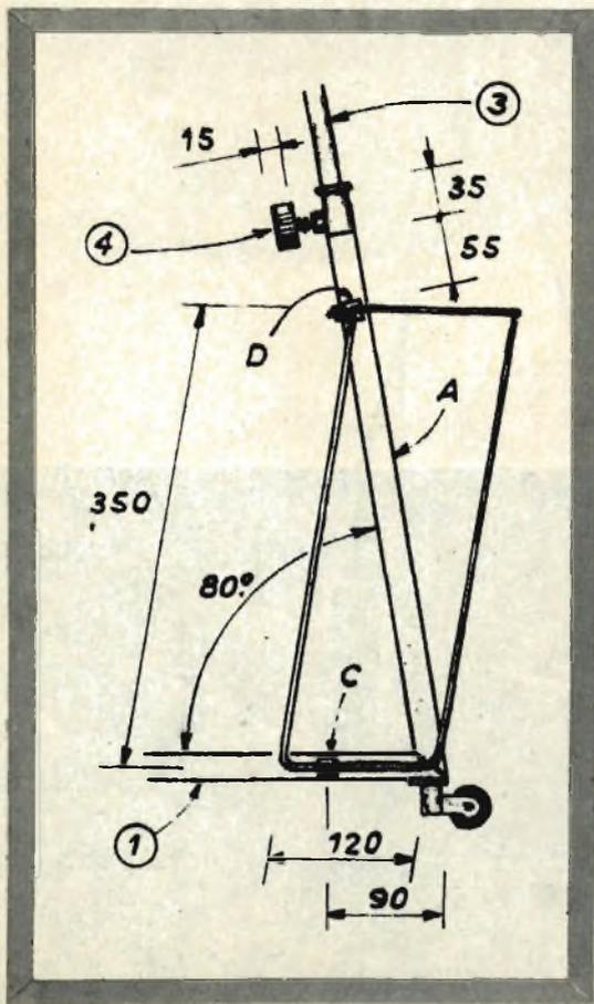
tipica sarà montato nelle sbarre A del telaio, risulti perfettamente parallelo alle due sbarre di base del tavolino (1).
