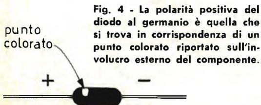
Fig. 4 - La polarità positiva del diodo al germanio è quella che si trova in corrispondenza di un punto colorato riportato sull'involucro esterno del componente.
