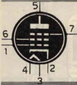
6CB6 PENTODO AMPL. PER TV (zoccolo miniatura)
