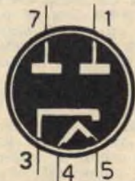
6CA4 DOPPIO DIODO RADDRIZZATORE (zoccolo noval)
