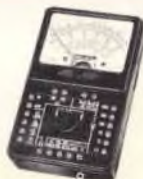
PRATICAL 10 analizzatore portatile 10000 ohm/volt
