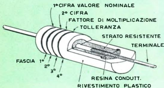
Fig. 1 - Struttura interna dei resistori a composizione.
