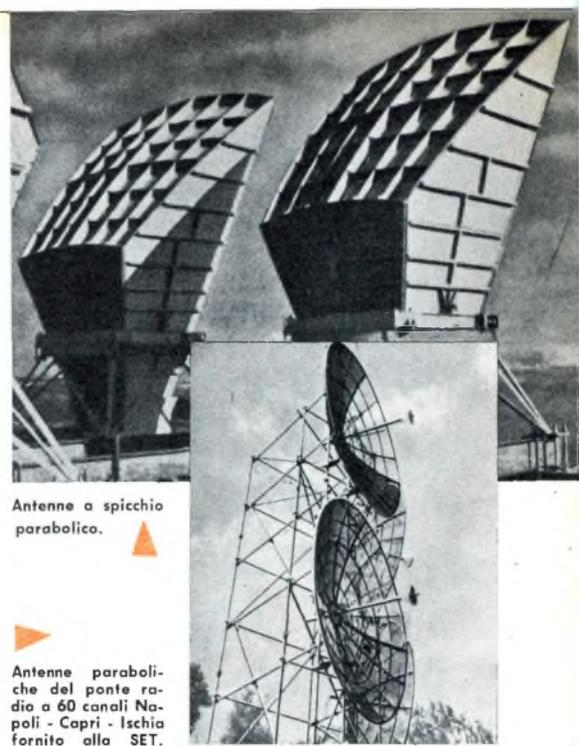
Antenne a specchio parabolico. ▲
