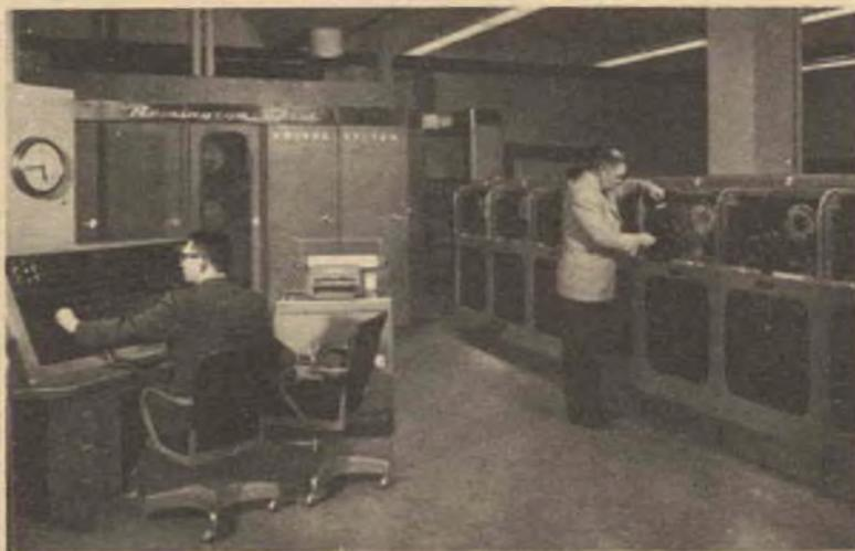
Una calcolatrice in azione. In fondo alla sala la sezione delle macchine contenente la memoria a mercurio
