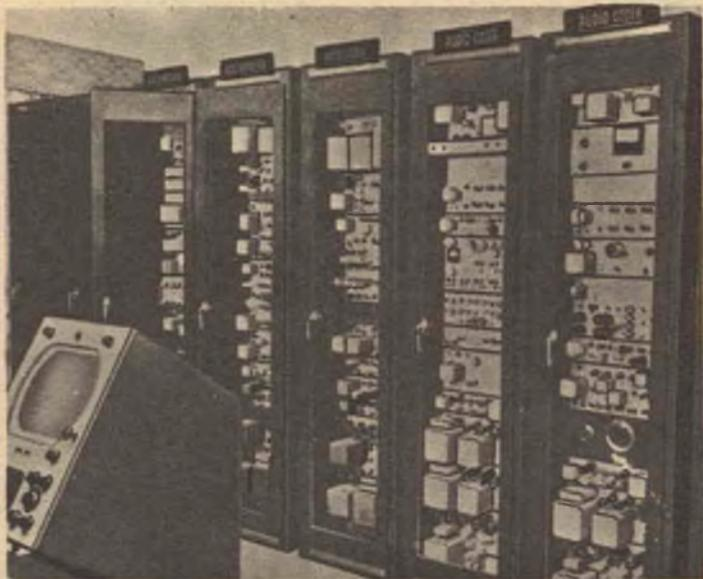
In questa foto i macchinari usati dalla Zenith, per rendere « incomprensibile » la trasmissione televisiva. In primo piano il « monitor » mediante il quale i programmi sono tenuti sotto un continuo controllo. Questa apparecchiatura è piuttosto complessa, però ve ne sono altre alquanto più semplici. Il sistema a circuito chiuso non farebbe uso di tali artifici in quanto i programmi verrebbero inviati agli abbonati mediante un comune sistema a fili tipo telefonico.
