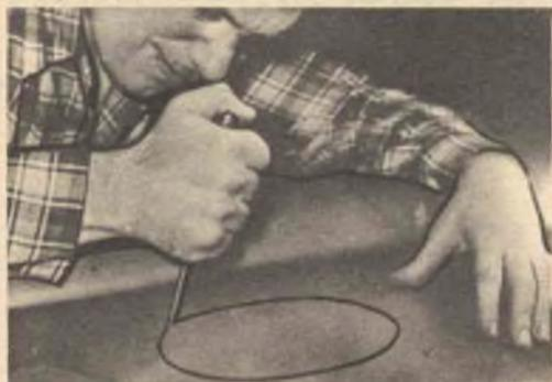
**Usando un coltello ben affilato, seguite con cura la linea precedentemente tracciata; indi collocate lo schermo acustico, infilando le viti nei fori già eseguiti; montate infine l'altoparlante dal disotto, nell'interno del baule, usando un peso per tenere a posto le quattro viti con cui lo dovrete fissare.**
