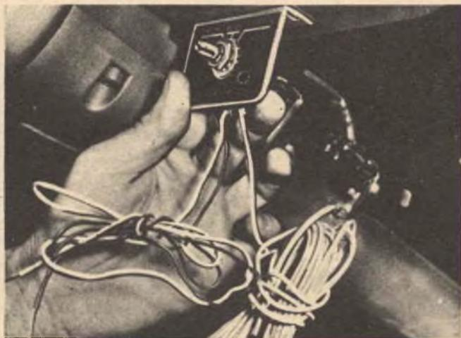
Il commutatore a due vie tre posizioni, installato sotto il cruscotto, vi permetterà di far funzionare ambedue gli altoparlanti, ovvero di escludere ora l'uno ora l'altro. A tal uopo saldate al contatto centrale (cursore) di una via del commutatore un breve spezzone di filo rosso per l'altoparlante anteriore e all'altro, della seconda via, uno spezzone più lungo, per l'altoparlante posteriore.
