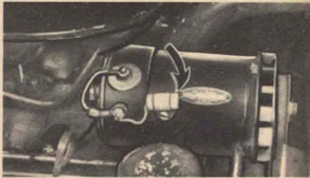
Il condensatore collegato tra la carcassa della dinamo ed il conduttore centrale di essa serve ad eliminare i disturbi dovuti al generatore di tensione.
