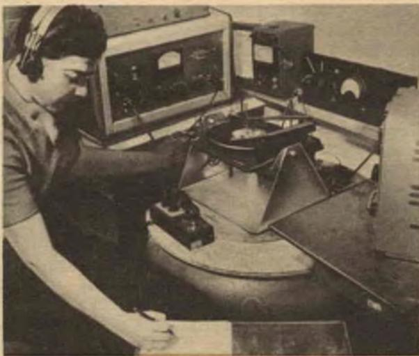
La « risposta » del fonorilevatore viene controllata mediante la riproduzione di un disco apposito, su cui sono incisi suoni di particolare tonalità e intensità. Un apposito strumento (a sinistra nella foto) misura direttamente la percentuale di distorsione del fonorilevatore, mentre l'operatore ne controlla il funzionamento mediante auricolari.
