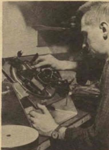
Il collaudo vero e proprio comincia con la verifica e la messa a punto di ogni parte. Il giradischi viene montato su uno speciale sostegno snodabile. Si controlla la distanza del braccio dal piatto, la scorrevolezza dei perni, la pressione della puntina e il dispositivo di frizione che determina le diverse velocità.
