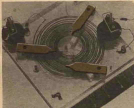
La « molla d'orologio » illustrata sopra è in realtà una linea di torsione ritardata, apparato usato in applicazioni come calcolatrici, circuiti a innesco ritardato e misuratori delle portate del radar. Costruita dai Laboratori della Bell Telephone, è fatta di vibralloy, una lega ferromagnetica. La spirale permette una chiara risoluzione di impulsi di 10 microsecondi spaziali di 20 microsecondi.
