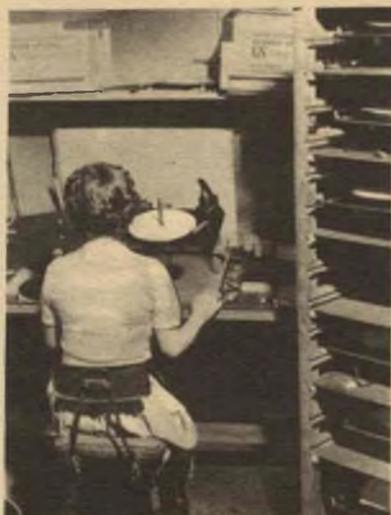
Un dato numero di giradischi viene presentato ogni volta su uno scaffale mobile all'operatore addetto al controllo. È sufficiente che si scopra un difetto in uno solo di questi apparecchi perchè tutti gli altri subiscano daccapo l'intero ciclo di prove, da quelle più propriamente meccaniche alle prove di funzionamento con dischi, amplificatore e altoparlante. Dopo il controllo gli apparecchi vengono finalmente inviati al reparto ove avviene l'imballaggio e la spedizione.
