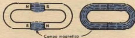
Fig. 3 - I poli magnetici sembrano scomparire quando due magneti a U sono avvicinati in questo modo.
