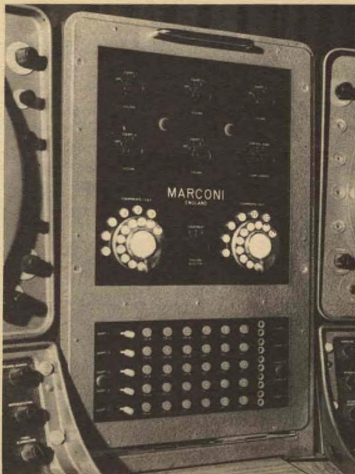
Il pannello di controllo radio VMP comprende i controlli, i servizi di ricerca (in alto) e il selettore di canale RT (in basso).
