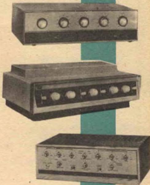
Gli amplificatori sopra illustrati hanno tutti controlli variabili di tono capaci di fornire esaltazione e attenuazione di  $\pm 16$  dB. I controlli di altezza sono tuttavia differenti. L'apparacchio in alto ha tre posizioni di compensazione, quello al centro ha un controllo variabile con continuità, quello più in basso ha un commutatore che inserisce ed esclude il compensatore di altezza.
