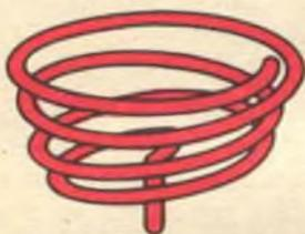
Il disturbo causato dalle ruote, dovuto ad un loro contatto intermittente con il telaio e alla conseguente scarica di elettricità statica, può essere eliminato con l'installazione di una molla ad elica posta nell'interno del cappello parapolvere.
