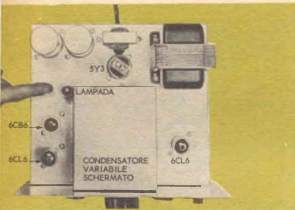
La lampada da 3 W regolatrice di tensione in questo generatore è stata montata sulla parte superiore dello chassis.
