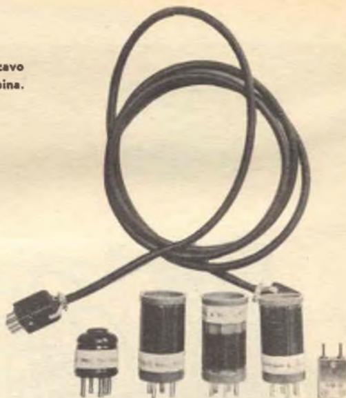
to bassi con il controllo di reazione R6; lo strumento M1 indicherà solamente quando il cristallo è in oscillazione e darà una indicazione relativa dell'attività di un cristallo. Se desiderate usare un cristallo funzionante sulle armoniche, mettete la bobina dell'oscillatore nello zoccolo portabobina; la bobina è fatta in modo da risuonare alla frequenza del cristallo quando essa è accordata con C1 (se la frequenza fondamentale è al disotto dei 10 MHz, usate l'adattatore per cristallo).
