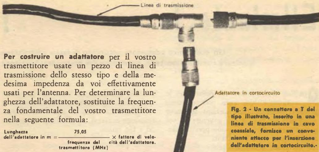
**Fig. 2 - Un connettore a T del tipo illustrato, inserito in una linea di trasmissione in cavo coassiale, fornisce un conveniente attacco per l'inserzione dell'adattatore in cortocircuito.**
