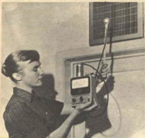
Con un elettrometro munito di sonda si rileva la presenza di aria ionizzata. L'apparacchio riprodotto nella foto determina se il condizionatore sta emettendo aria ionizzata.
