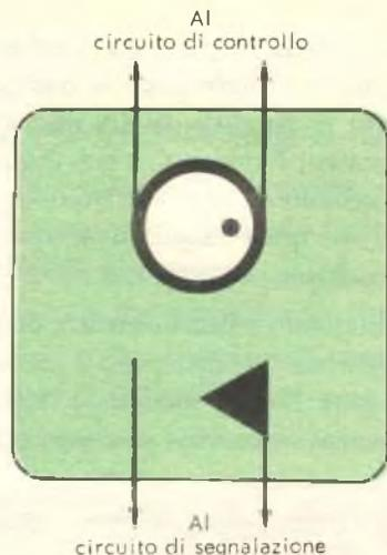
**Fig. 2** - Simbolo adattato per il *raysistor*; si noti che non esiste alcuna connessione elettrica fra i circuiti di controllo e di segnalazione.
