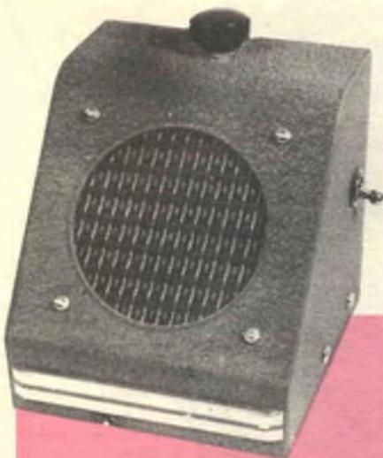
Possibile sistemazione dell'oscillofono in una custodia per strumenti; la manopola posta in alto serve a regolare la frequenza.
