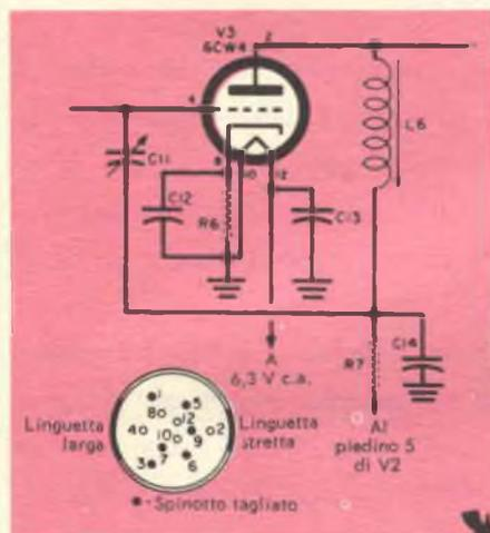
Il semplice stadio amplificatore in RF illustrato nello schema in alto a sinistra, impiega un triodo nuvistore. Lo stadio può venir inserito nel circuito del convertitore per 6 metri (schema a destra), fra i condensatori C3 e C4 come è spiegato nel testo.
