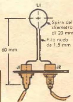
Schema elettrico del transidip; i dettagli costruttivi della spira di accoppiamento L1 sono illustrati sopra; a sinistra sono riportati i particolari per il montaggio del condensatore C5.
