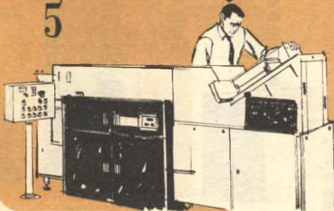
zione. A mano a mano che ciascuna lettera viene a trovarsi sotto questo dispositivo, fa entrare in azione questo circuito a cellula fotoelettrica che effettua il processo di lettura; una specie di raggio scorre avanti e indietro sulla lettera in modo simile a quello del raggio di elettroni che si sposta avanti e indietro attraverso lo schermo del televisore e crea l'immagine.
