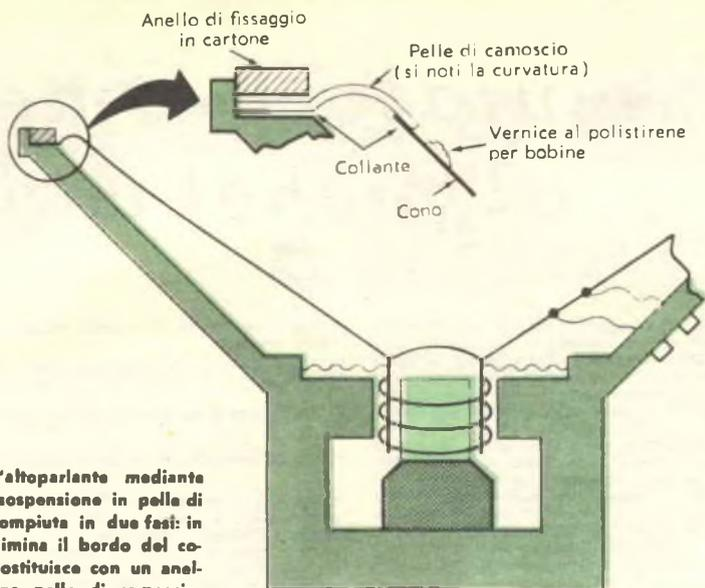
La modifica dell'altoparlante mediante aggiunta di una sospensione in pelle di camoscio viene compiuta in due fasi: in primo luogo si elimina il bordo del cono, quindi lo si sostituisce con un anello ricavato da una pelle di camoscio.
