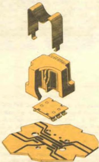
Il relè « Printact » agisce sulla basetta a circuito stampato sottostante (come si vede dalla vista esplosa dell'unità). I conduttori stampati costituiscono i contatti permanenti sulla basetta.
