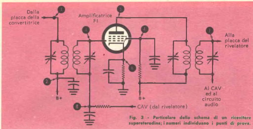
Fig. 3 - Particolare dello schema di un ricevitore supereterodina; i numeri individuano i punti di prova.
