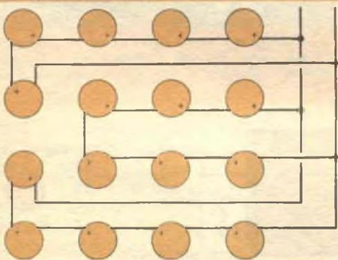
*gando il sistema in questo modo si porteranno più efficientemente gli altoparlanti sotto l'effetto di controllo del circuito di reazione dell'amplificatore.*
