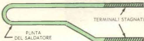
Alcuni saldatori istantanei presentano il difetto di riscaldarsi molto lentamente a causa di un imperfetto collegamento elettrico sui contatti della punta. Questo fatto di solito è dovuto all'ossidazione del rame sui terminali della punta; se però questi sono stagnati prima di essere inseriti sul saldatore, l'ossidazione verrà ritardata.
