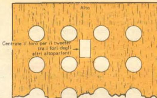
Posizione del tweeter sul pannello degli altoparlanti. Le dimensioni dell'apertura variano a seconda dell'unità adottata.
