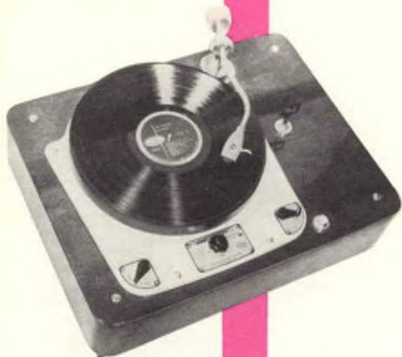
I giradischi professionali come il Garrard 301 sono forniti senza il braccio, in quanto sono destinati a speciali installazioni. L'unità qui presentata è a tre velocità ed è munita di controllo delle correnti parassite per ciascuna velocità; impiega un piatto di alluminio del peso di circa 3 kg ed un motore a quattro poli particolarmente robusto; un sistema incorporato, a pressione, assicura una continua lubrificazione di tutte le parti.
