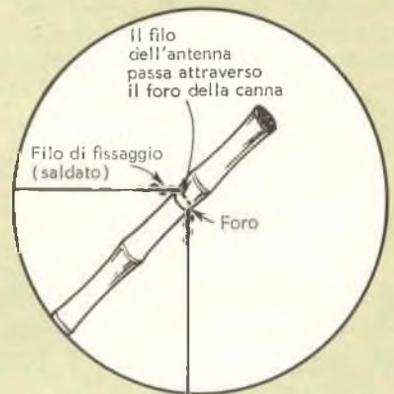
Fig. 2 - Per la costruzione dell'antenna è necessario preparare due telai a sezione quadrata. Il filo viene fatto passare attraverso i fori praticati agli estremi delle canne e quindi fissato, per sicurezza, con un tratto di filo di rame (ved. particolare in alto). Per tendere uniformemente i fili allentate le staffette ad U che fissano le canne e spingete verso l'esterno le canne stesse.
