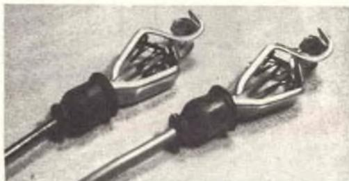
Infilando un cappuccio di plastica o di gomma (del tipo usato nelle automobili per proteggere l'ingresso dei fili delle candele nel distributore dell'alta tensione) sulla connessione eseguita tra un filo ed una pinzetta a bocca di coccodrillo irrobustirete la giunzione e la renderete meno soggetta a rotture; inoltre l'insieme avrà un aspetto più ordinato.
