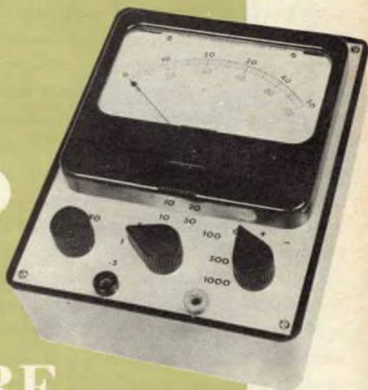
**Questo strumento, che impiega un solo transistor ad effetto di campo, è portatile, preciso ed ha un'impedenza d'entrata estremamente alta.**
