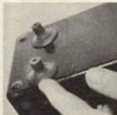
Usando semplici ventose potrete fabbricare ottimi piedini di gomma per i vostri strumenti. Le ventose si possono incollare con gomma liquida o, volendo, si possono forare e fissare al mobiletto mediante una vite con dado. Le ventose sono flessibili
