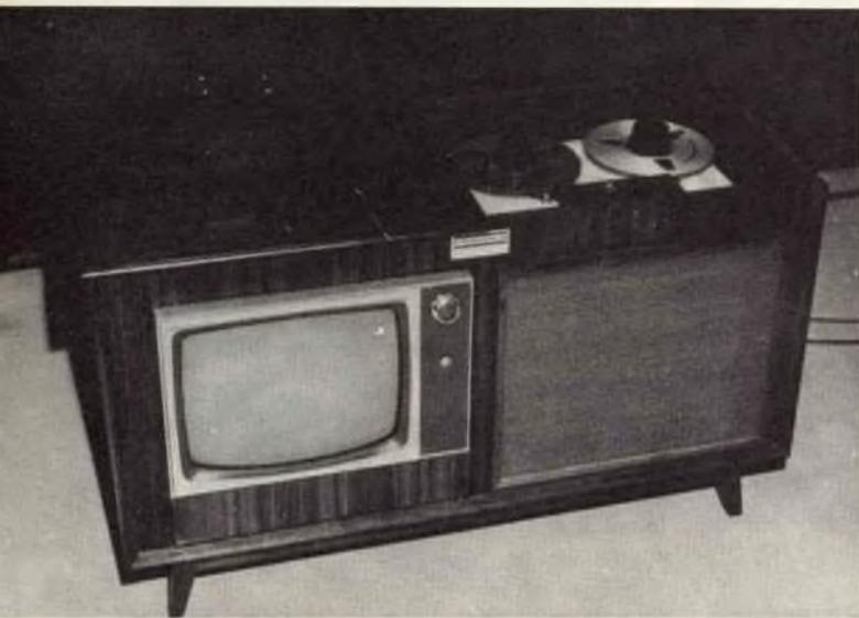
Il registratore a nastro, che qui si vede installato nello stesso mobile del televisore, sarà anche costruita come unità separata. Richiede solo tre collegamenti al televisore: uno per l'audio, uno per il video ed uno per il sincronismo orizzontale. L'audio viene registrato con un sistema multiplex e viene aggiunto al video per formare un segnale composto che viene registrato sul nastro. Le testine di registrazione e di riproduzione sono separate l'una dall'altra.
