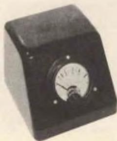
Le vecchie scatole per amplificatori d'antenna TV o di controllo per rotatori d'antenna del tipo illustrato sono ottime per il montaggio di strumenti o di altoparlanti miniatura. Dopo aver svuotato completamente la scatola accertatevi se lo strumento o l'altoparlante possono essere montati nel foro già esistente nella parte frontale della custodia. Se ciò non è possibile allargate il foro con un seghetto da traforo, quindi praticate gli altri fori di montaggio per le viti.
